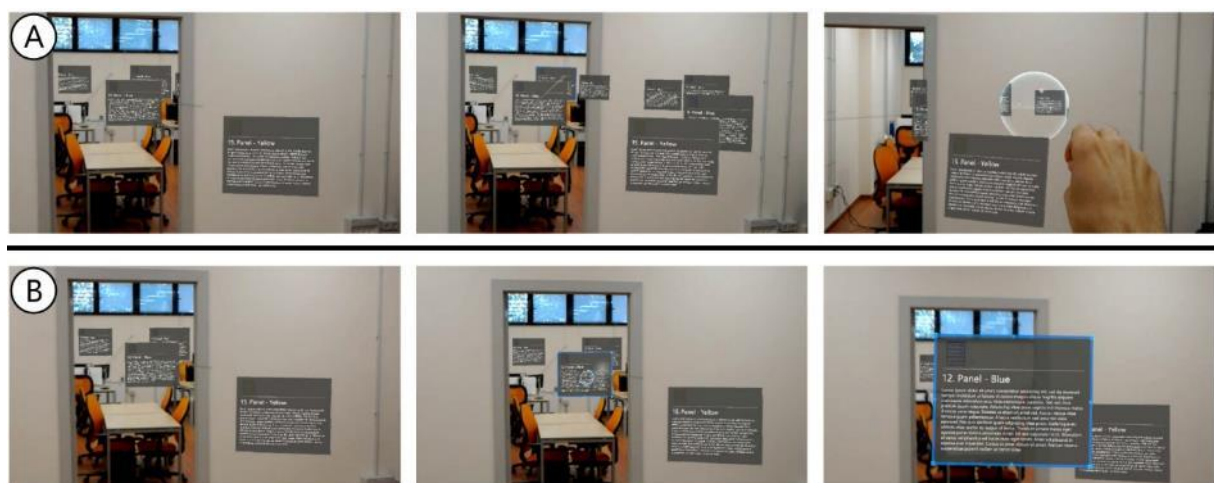
Figure 2.6 – Exploration du « information-seeking mantra » pour des données situées à l'aide d'un casque HoloLens (Caggianese et al., 2019) avec (A) la vue d'ensemble et (B) la manipulation directe pour avoir des détails sur l'information
