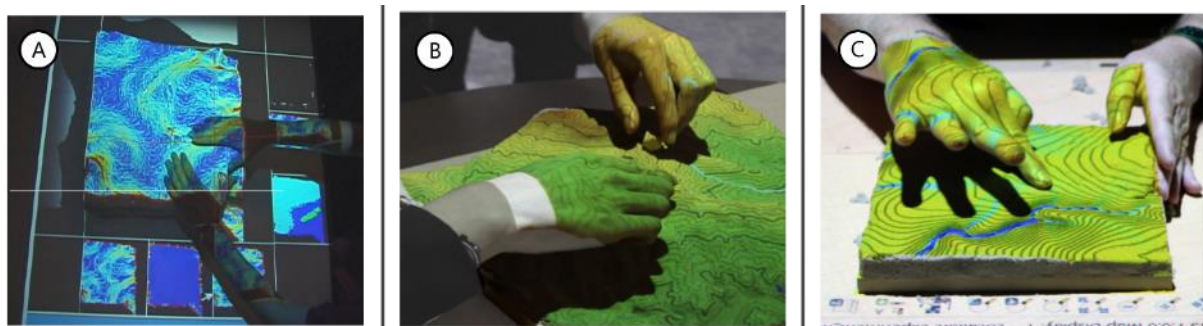
Figure 2.9 – Différents systèmes de visualisation de données situées sur un relief physique avec (A) Illuminating Clay (Piper et al., 2002), (B) Tangible Landscape (Millar et al., 2018) et (C) une visualisation d'écoulement de l'eau et son impact sur le relief (Harmon et al., 2016)
