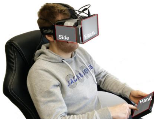
Figure 2.17 – Les trois emplacements du pavé tactile évalués dans (Gugenheimer et al., 2016)
